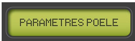
La touche SET permet de modifier les paramètres principaux du poêle comme le chargement des granulés, la vitesse de l'aspirateur des fumées, le ventilateur d'air ambiant et la correction de la température ambiante. Les touches TEMP+ et TEMP- permettent de modifier, en pourcentage, les paramètres du poêle pour
