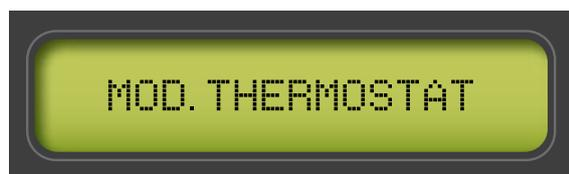
La touche SET permet de modifier le mode de fonctionnement pour le contrôle de température de marche/arrêt automatique.
