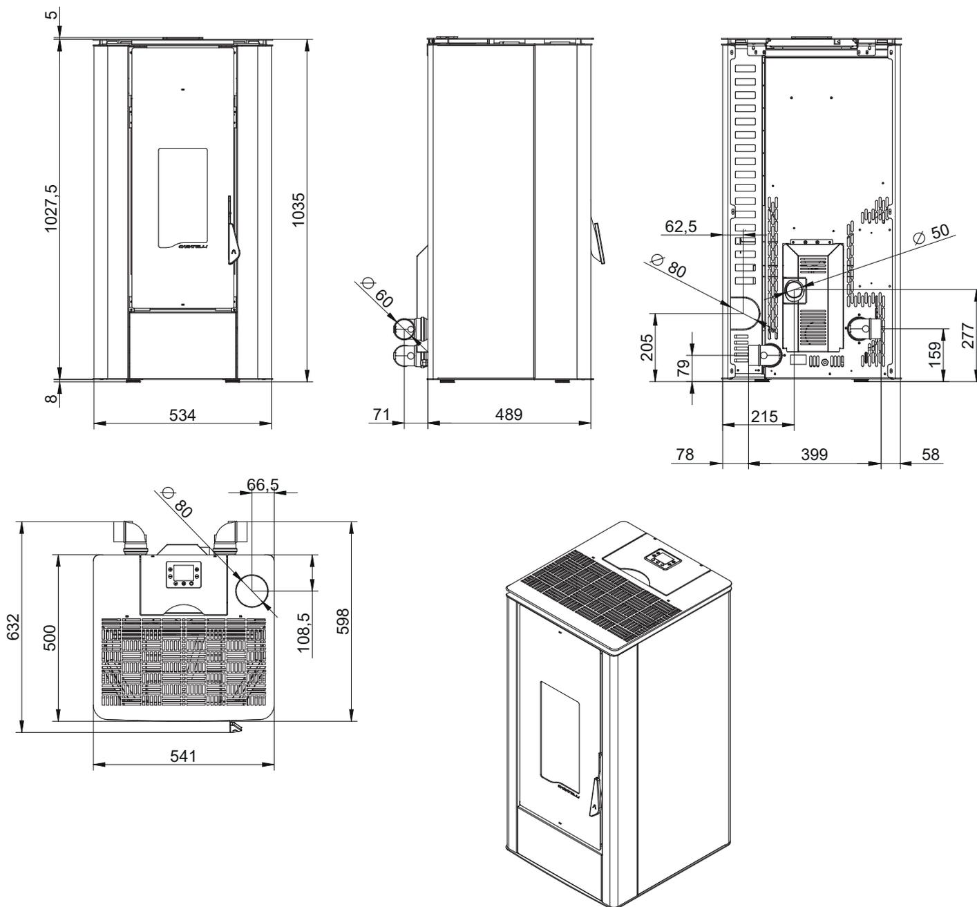
Dimensioni (mm) - Dimensions (mm) - Abmessungen (mm)
