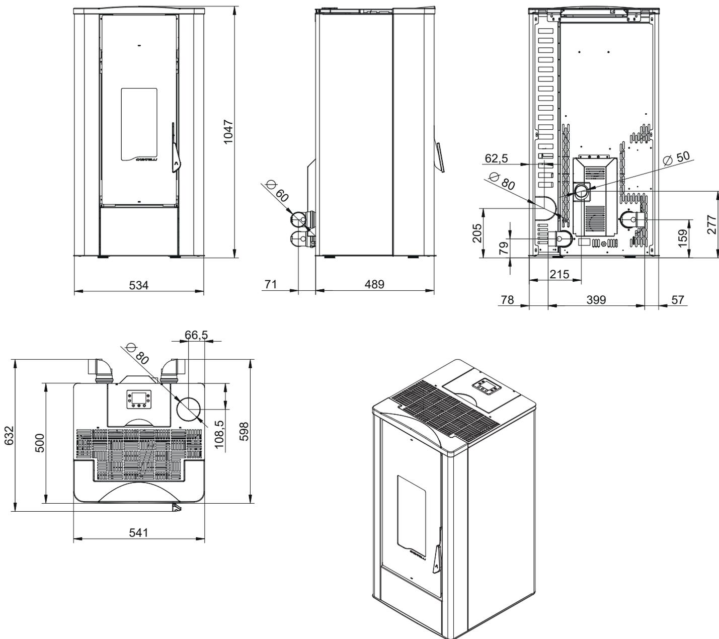
Dimensioni (mm) - Dimensions (mm) - Abmessungen (mm)
